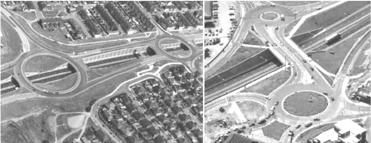
Slika 2. Petlje sa kružnim tokom (sa dva i sa jednim mostom)
